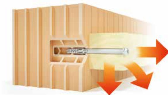
Rys. Oddziaływanie sił: rozciągających, ścinających, zginających
